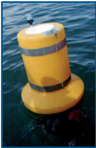
Figures 4 et 5. Bouée contenant un système de mesure de la température de l'eau dans la zone de rejet (gauche); système de mesure du courant de surface dans la zone du rejet (droite)
