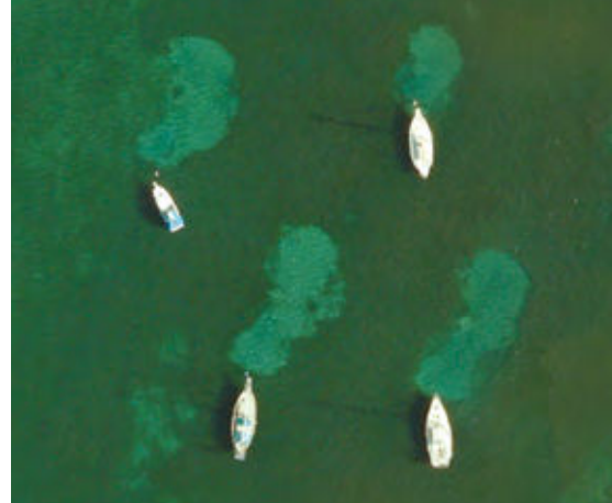
Impact des zones de mouillage des bateaux sur les herbiers : zones claires exemptes de végétation aquatique qui résultent du va et vient de la chaîne reliant la bouée d'amarrage au corps mort, arrachant ainsi les plantes quand le bateau tourne en fonction du vent. Photo Données OpenData du SITG (Etat de Genève)
