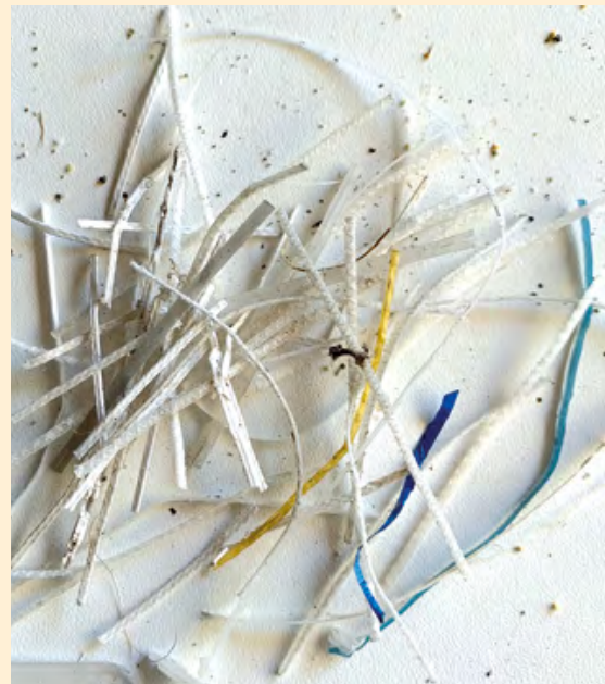
Fibres de plastique incorporées dans le béton à projeter. Photo ASL
