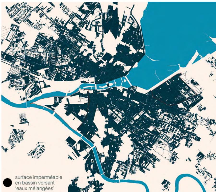
Figure 1. Carte des surfaces imperméables en bassins unitaires. Les zones noircies représentent les surfaces sur lesquelles l'eau de pluie finit dans une station d'épuration. © Robin Ossent, base de données SITG, 2023.
