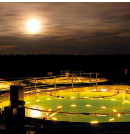
Dispositif expérimental pour l'étude de la pollution lumineuse sur l'évolution des peuplements de cyanobactéries, constitué d'enclos immergés dans un lac dans lesquels on inocule des cyanobactéries ( https://www.igb-berlin.de/en/infrastructure/lakelab ). Photo Andreas Jechow
